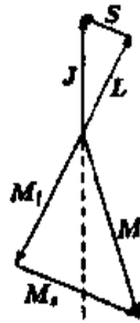
图12.3 轨道角动量( L )与自旋( S )的矢量和, 以及相应的磁矩 M_L 与 M_S 的矢量和.
