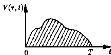
图11.2 在 0 \leq t \leq T 时间内微扰的一般形式。这种微扰是可以实现的，例如，在 T 时间间隔内接通外场；或入射一个粒与之碰撞(相互作用)。
